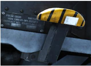
黒と黄色のストライプが入ったキャノピージェットハンドルは、両コックピットとも計器パネルのすぐ後方、左のキャノピーシルの下にある。ハンドルの内側にあるロック解除ボタンを押しキャノピージェットシステムが作動する。
