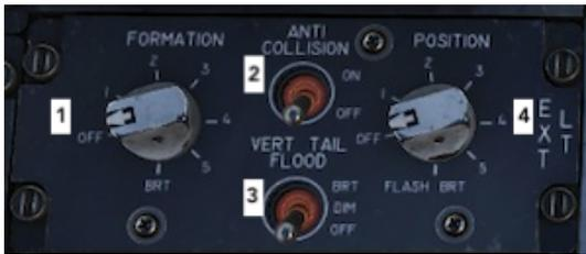
1. フォーメーションライト ノブ 6つのポジションライト（翼端に2つ、コックピット前方の胴体左右に1つずつ、主翼後方の胴体後部に1つ）の明るさを調節します。
