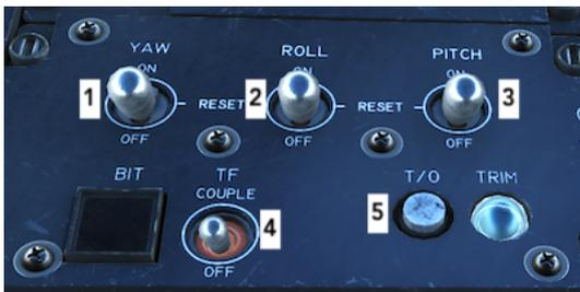
1. YAW CAS 3ポジションスイッチ。ON でエンゲージ後の通常操作が可能。切断された軸は、切断の原因となったフォルトが存在しなくなった後に接続されます（スプリングでONに戻ります）。OFFは該当する軸の接続を解除する。
