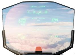
ホログラフィック・コンバイナーは、仰角21°、方位角28°の全視野に投影されたラスター(映像)とストローク(シンボル)画像を表示する。HUDは、ナビゲーション、FLIRビデオ、飛行制御、武器運搬情報を表示する。詳細は第6章ヘッドアップディスプレイを参照。
