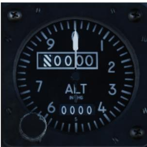
スタンバイ高度計は、静圧源から直接作動します。回転ポインターは数百フィート。現在の高度は上の窓のダイヤルに表示され、下の窓には現在選択されている気圧が表示されます。は現在選択されている気圧を水銀インチで表示します。
