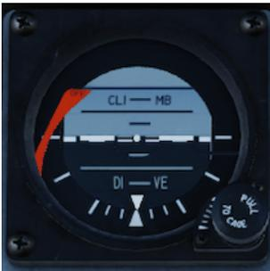
スタンバイ姿勢計は、自己完結型の電気駆動ジャイロ・ホライズンタイプの計器です。電源が無いか、ジャイロがケージに入っている場合、OFFフラグが表示されます。ジャイロのケージを外すにはパイロットはノブを引き、回転させてから離す。インジケータは360度回転、90度まで上昇、下降を表示する。度まで上昇し、78度まで下降します。
