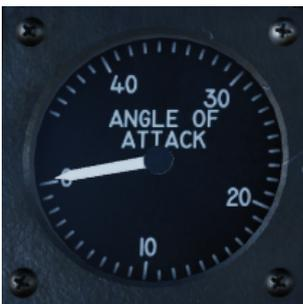
アタック角インジケータはフロントコックピットでのみ使用可能。単位は0から45。T字型のインデックスマークは、最適な着陸進入角（20から22の間）を示す。単位。インジケータに電源が供給されていない場合はOFFフラグが表示されます。
